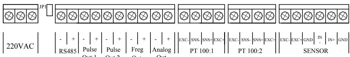
Клеммная панель конвертера в раздельном исполнении, вариант 1
