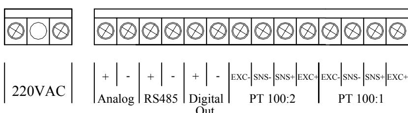
Клеммная панель конвертера в компактном исполнении
