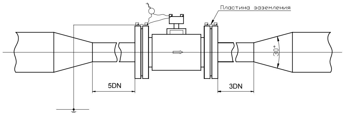
При установке в неметаллические либо футерованные трубопроводы, следует использовать специальные заземляющие кольца (за инструкциями обращайтесь к производителю или региональному дилеру)
