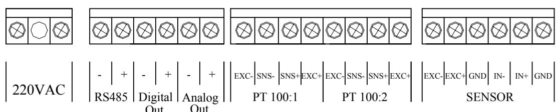
Клеммная панель конвертера в раздельном исполнении, вариант 2
