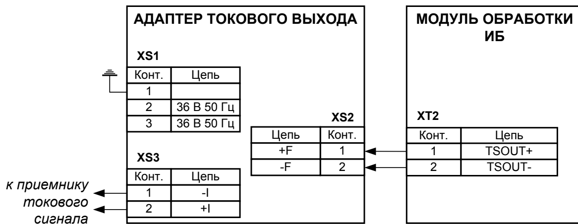
Рис. Г.2. Схема подключения адаптера.
