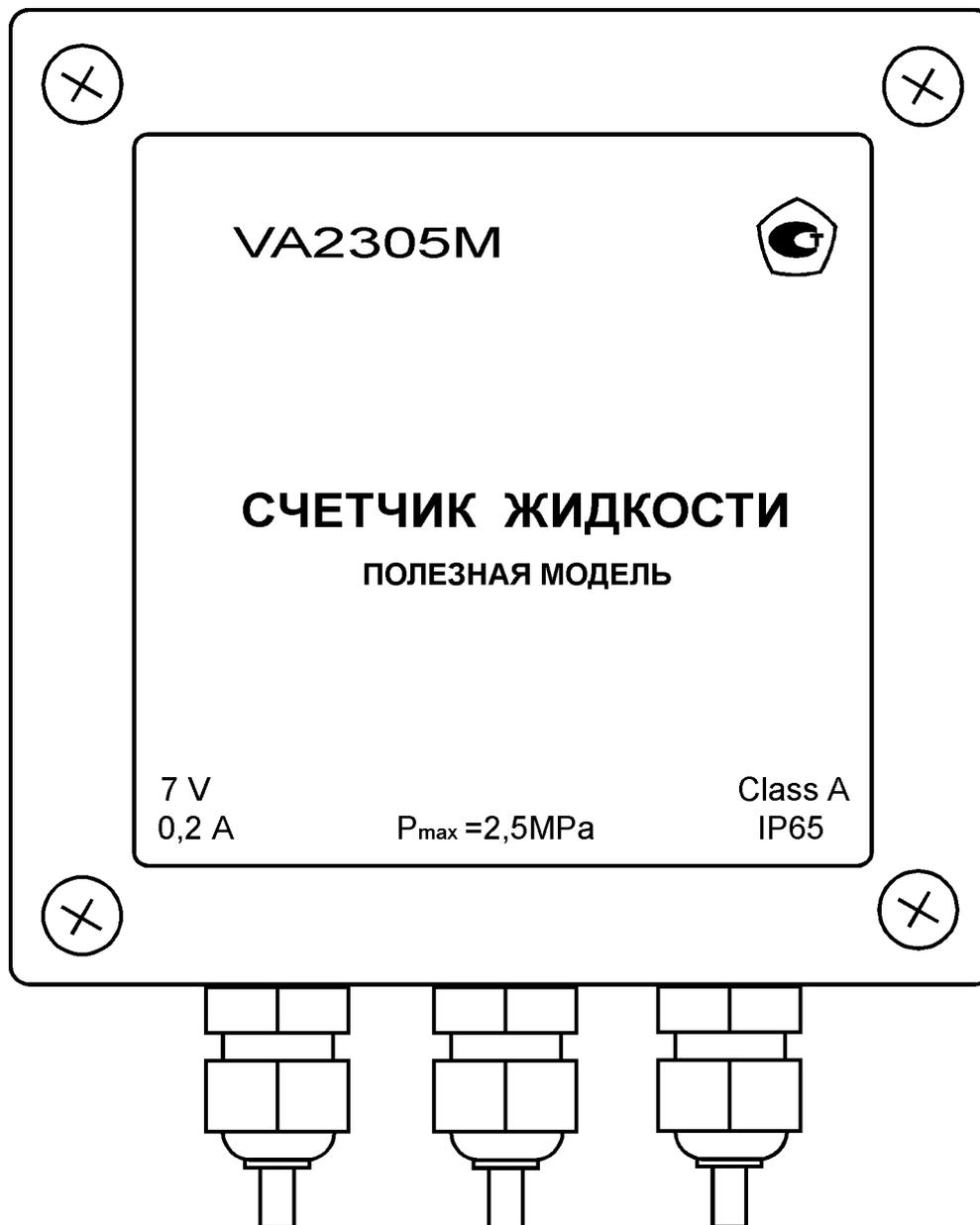
Рисунок 2 – Передняя панель электронного блока счетчиков без индикатора
