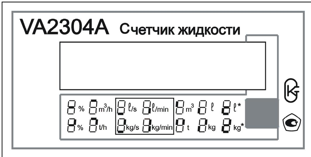
**Рисунок 7** – Вид спереди вычислительного блока щитового исполнения
