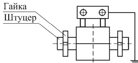
**Рисунок 17** – Схема заземления первичных преобразователей ЕКТМ
