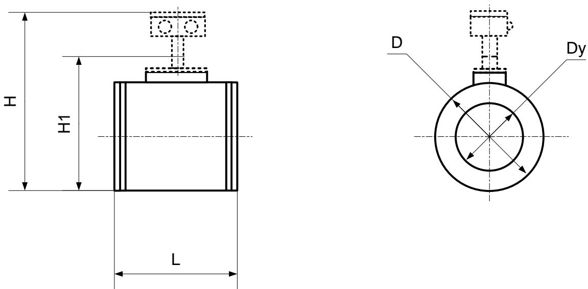
**ВНИМАНИЕ:** Транспортные фланцы (исполнение первичных преобразователей для Агрессивной жидкости) удалить перед монтажом и установить обратно при демонтаже.
