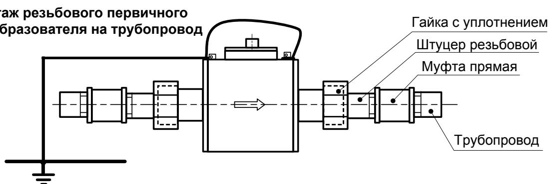
Рисунок Б.8 – Монтаж первичных преобразователей на трубопровод
