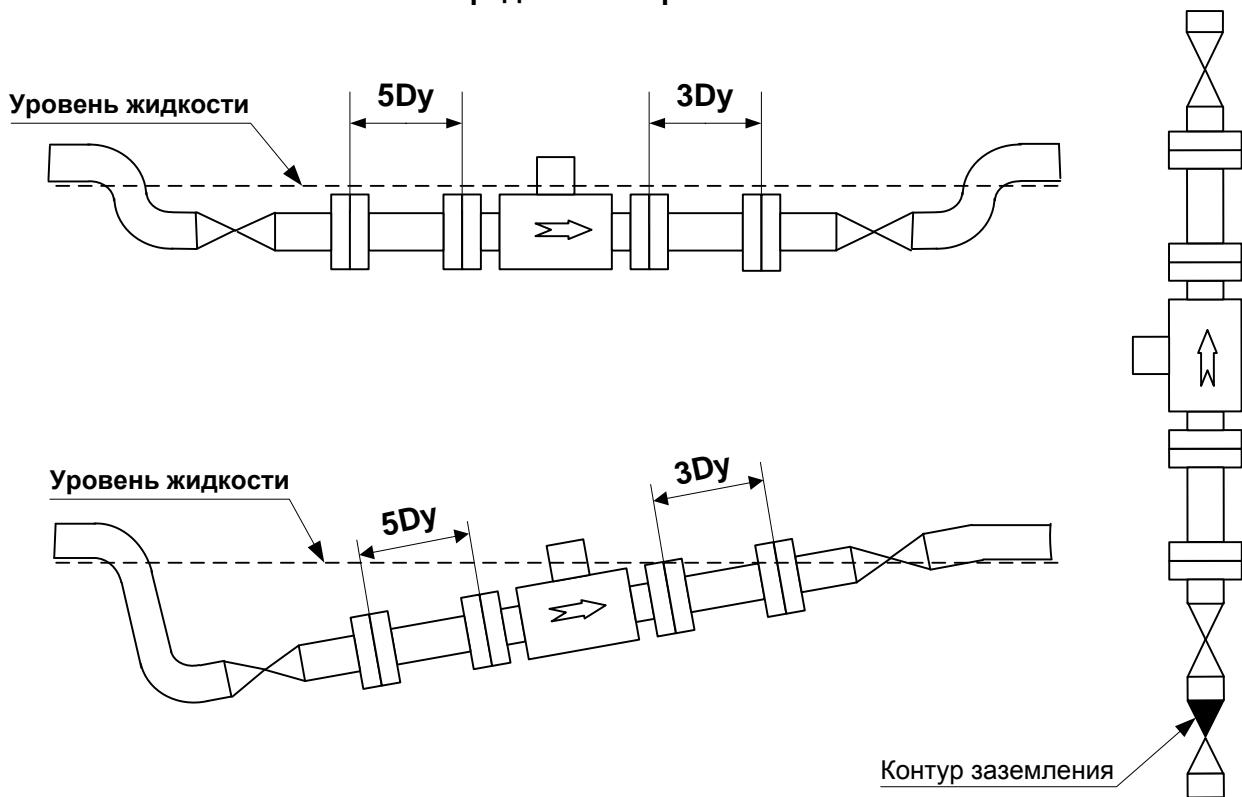
Рисунок Б.6 - Рекомендуемые варианты установки первичного преобразователя
