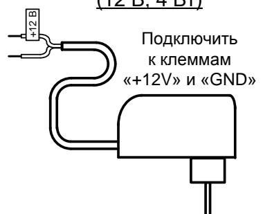
**Назначение соединительных клемм**
