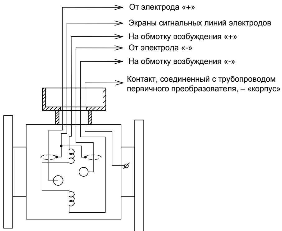
Рисунок Г.1 Общая схема первичного преобразователя расхода
