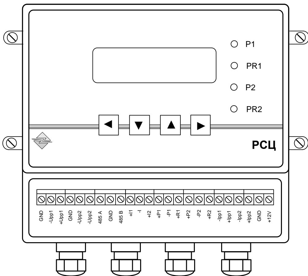
**Назначение соединительных клемм**
