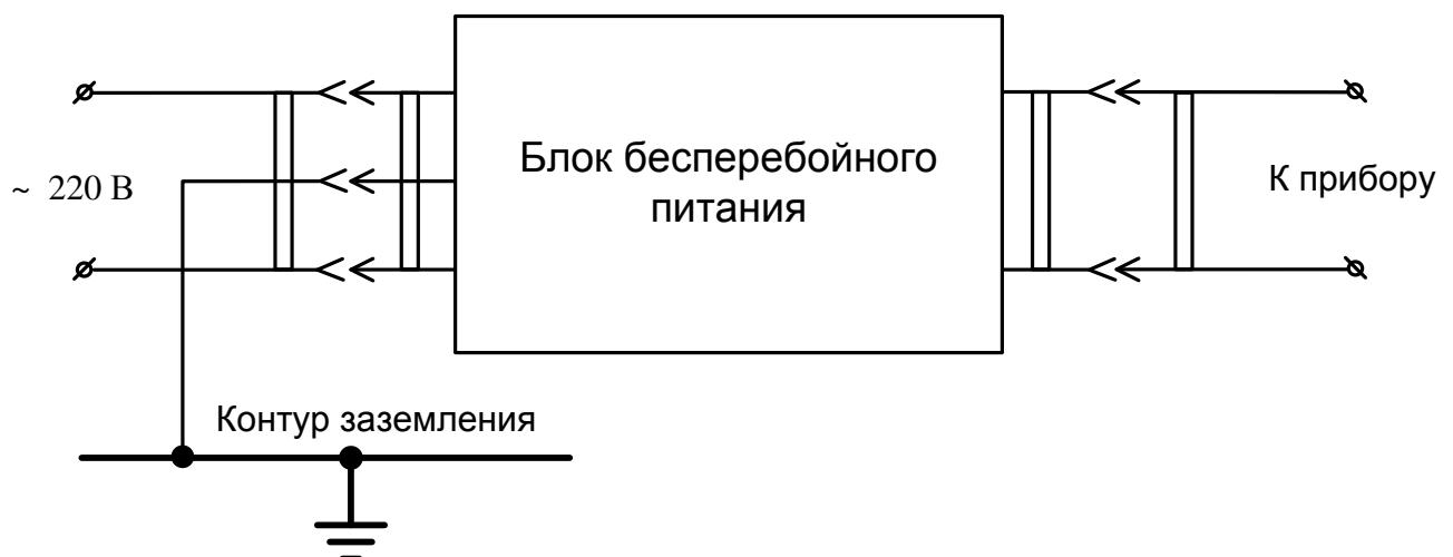
Рисунок Д.2 Схема включения РСЦ через блок бесперебойного питания
