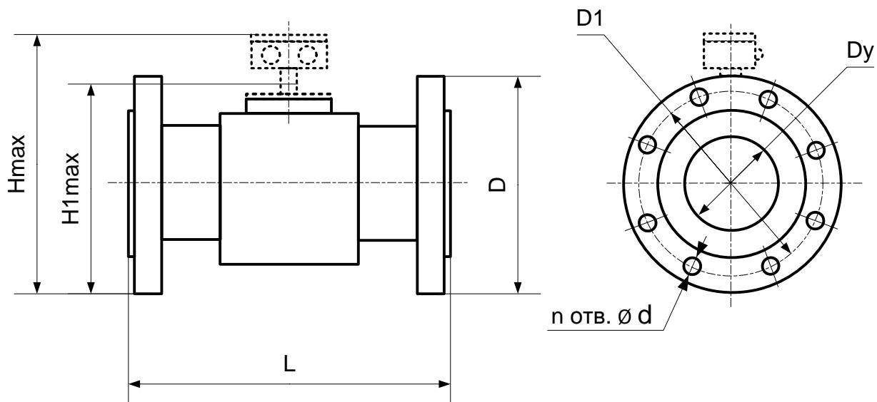
**ВНИМАНИЕ!** Транспортные фланцы (исполнение первичных преобразователей для Агрессивной жидкости) удалить перед монтажом и установить обратно при демонтаже.
