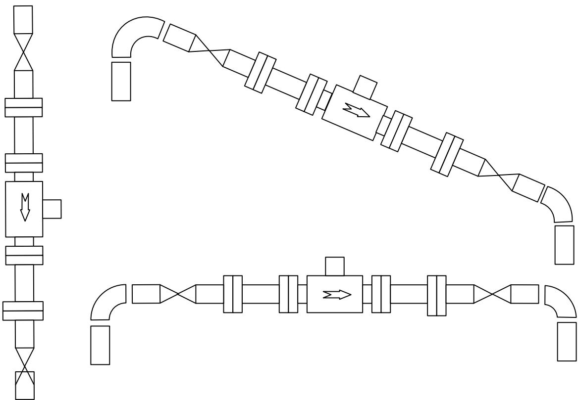
Рисунок Б.7 - Примеры НЕПРАВИЛЬНОЙ установки первичного преобразователя
