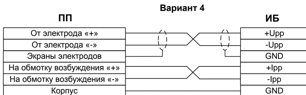
1. Для изготовления кабеля рекомендуется применять следующие провода:
