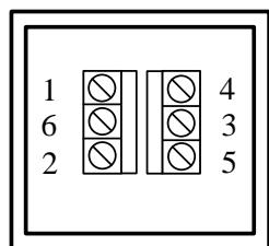
Назначение контактов для клеммных коробок типа 4
