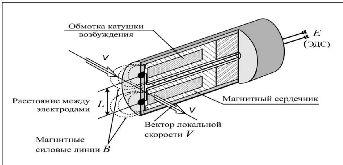
Рисунок 1 — Устройство и принцип работы датчика скорости потока
