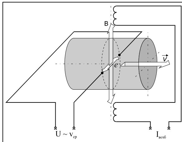
Рисунок 2 — Принцип работы полнопроходного датчика расхода
