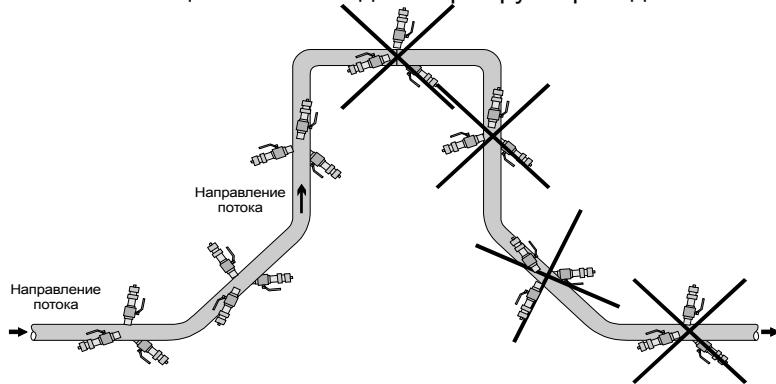
Рисунок 6 — Рекомендуемые и не рекомендуемые (перечеркнутые) места монтажа датчиков скорости ПРБ-3 (для ППР требования те же)
