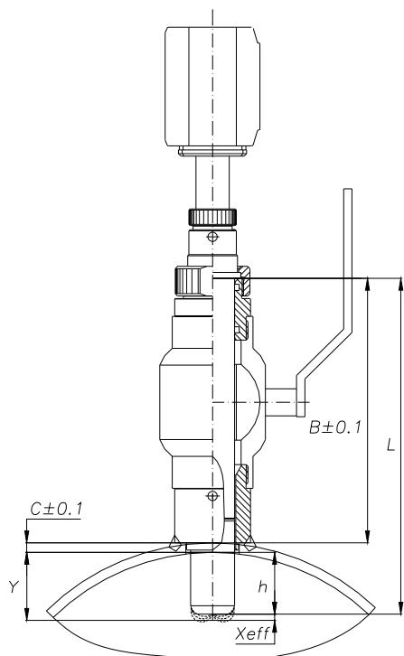
Рисунок 7 — Основные геометрические размеры датчика скорости DC при монтаже
