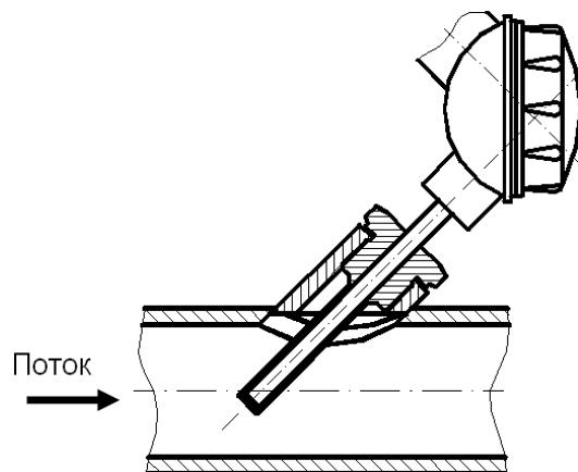
Рисунок Г.4 — Наклонная установка термометра сопротивления
