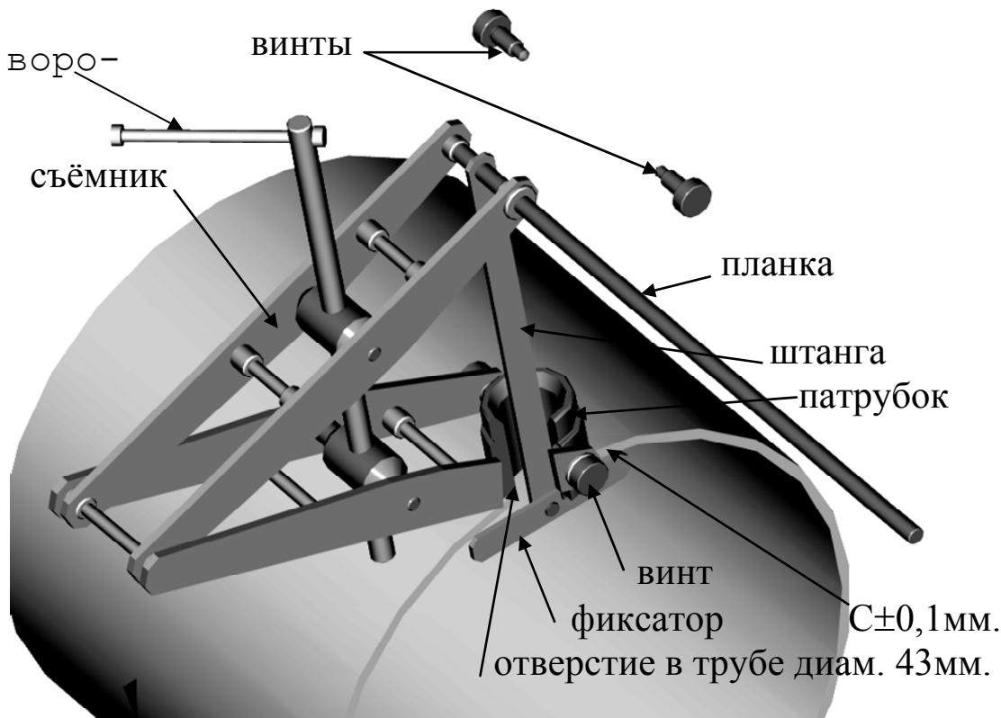
Рисунок 9 — Монтаж патрубка
