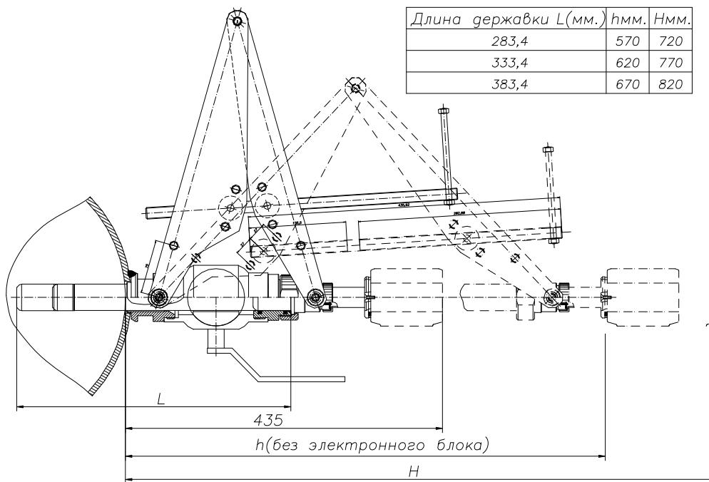
Рисунок 8 — Габариты и установочные размеры преобразователей скорости ПС
