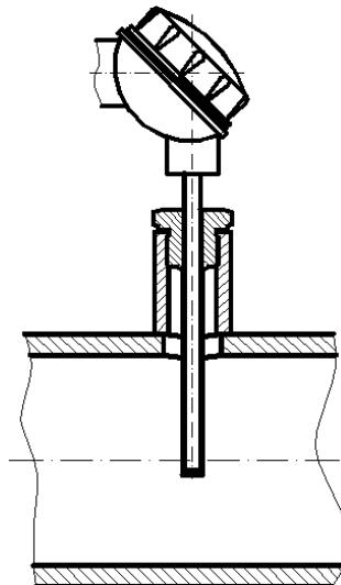
Рисунок Г.3 — Вертикальная установка термометра сопротивления
