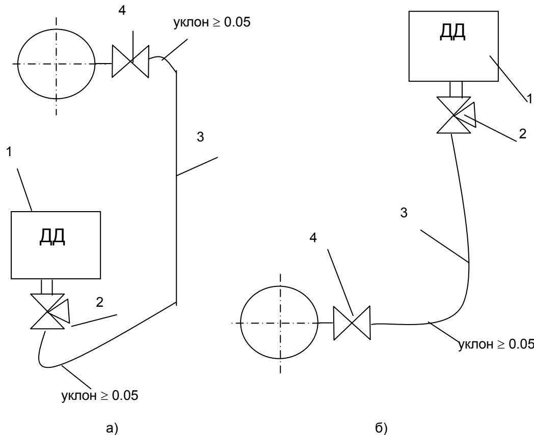
Рисунок 13 — Схемы присоединения датчиков давления на измерительном участке
