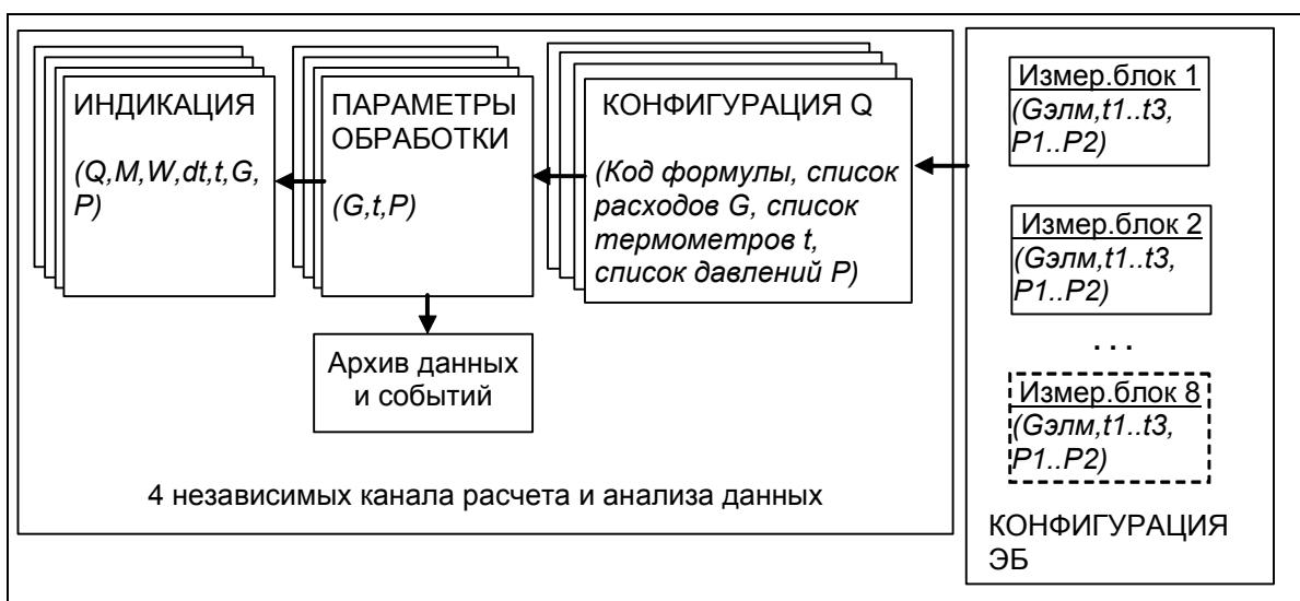
Рисунок Л.2 — Схема обработки данных в РМ-5-Б3
