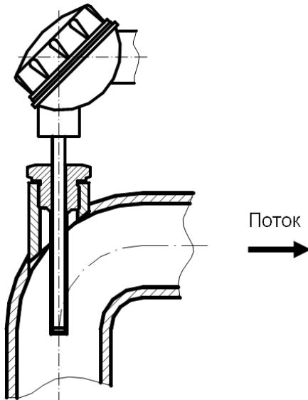
Рисунок Г.5 — Установка термометра сопротивления в колено
