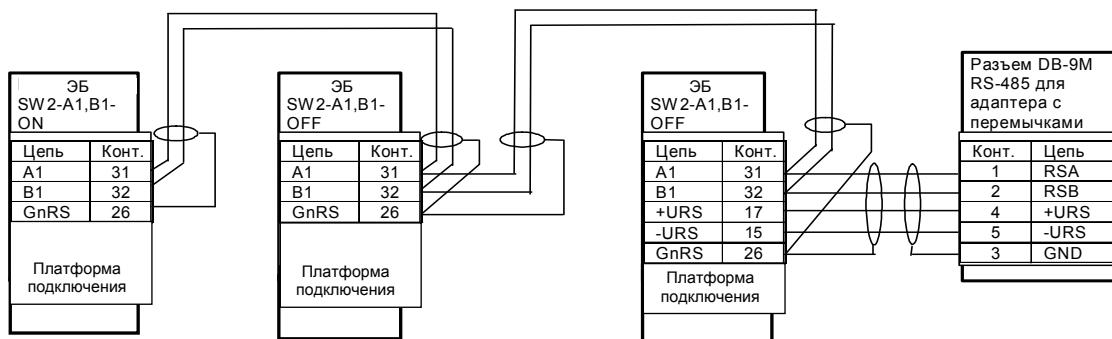
Рисунок Н.3 — Типовая схема сетевого соединения РМ-5-Б3
