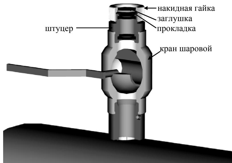
Рисунок 10 — Сборка шлюзовой камеры
