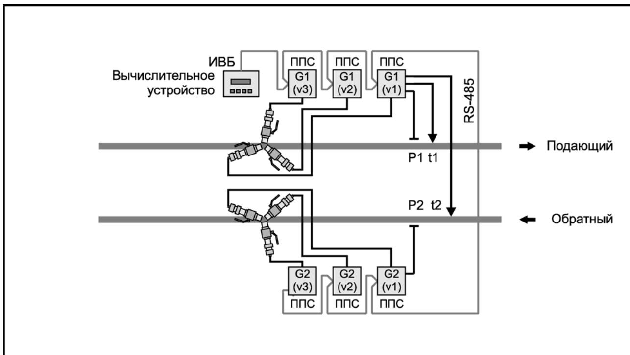
Рисунок Л.4 — Одна из типовых монтажных схем подключения РМ-5-Б3
