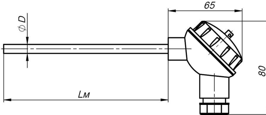
Диаметр монтажной части  $D$ , мм: 6; 8Стандартный ряд длин монтажной части  $L_M$ , мм: 100; 110; 130; 150; 170; 210; 250; 300; 370; 450; 550.**Гильзы защитные**
