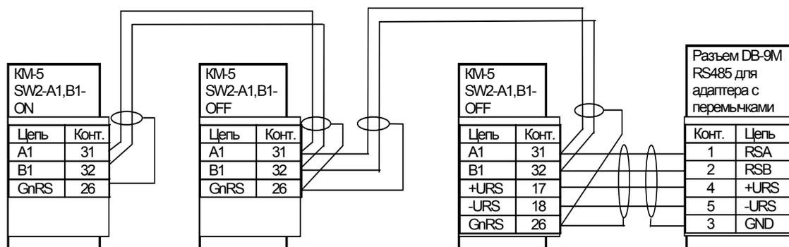
Рисунок Д.3 — Типовая схема сетевого соединения КМ-5
