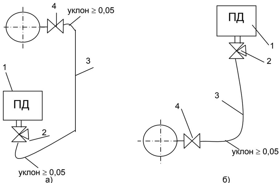
Рисунок 10 — Схемы присоединения датчиков давления на измерительном участке
