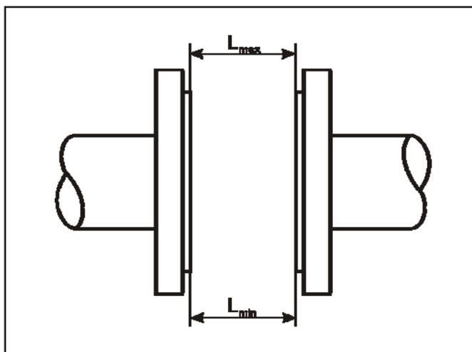
Рисунок 5 — Максимально допустимое отклонение фланцев трубопровода от параллельности
