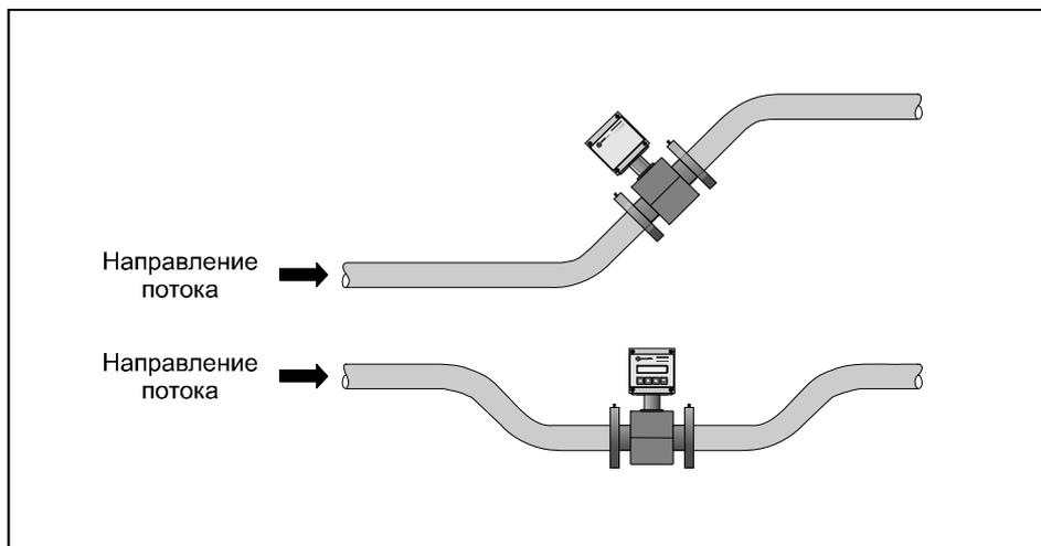
Рисунок 7— Рекомендованное размещение первичных преобразователей на горизонтальном трубопроводе
