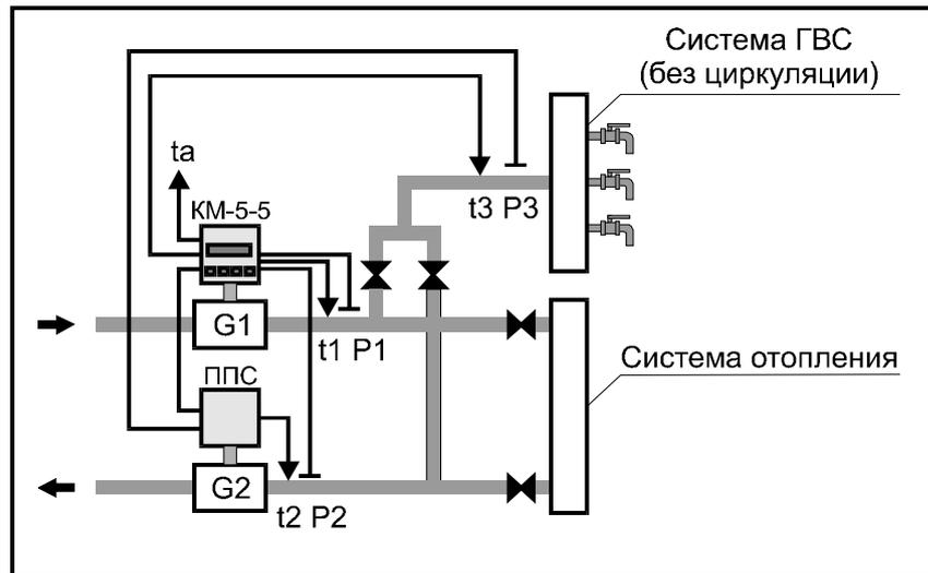
**Алгоритм вычисления тепловой энергии теплосчётчика КМ-5-5.**
