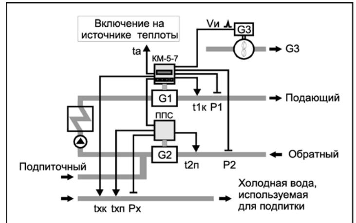
Алгоритм вычисления тепловой энергии теплосчётчика КМ-5-7
