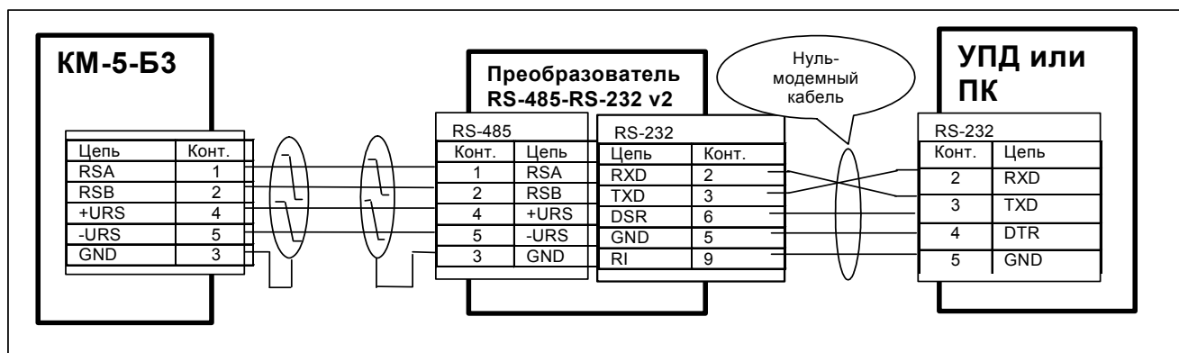
Рисунок К.1— Схема монтажа для подключения через преобразователь интерфейса
