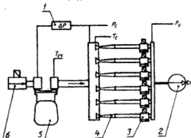
1 — дифманометр измерения потерь давления  $\Delta P$  на счетчике; 2 — вакуумный насос; 3 — выходные краны сопел; 4 — образцовое звуковое сопло; 5 — испытуемый счетчик; 6 — входной кран установки;
