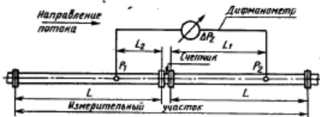
$\Delta P$  — потеря давления на участках трубопровода вверх и вниз по потоку и на счетчике;  $\Delta P_2 = (\Delta PL_1 + \Delta PL_2 + \Delta P_{\text{сч}})$ ;  $\Delta P_2 - \Delta P_1 = (\Delta PL_2 + \Delta P_{\text{сч}}) - (\Delta PL_1 + \Delta PL_2) = \Delta P_{\text{сч}}$
