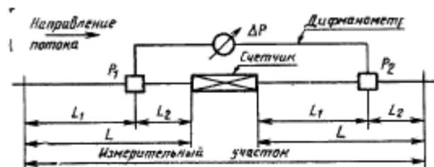
$P_1$  и  $P_2$  — отверстия для отбора давления,  $L \geq 15 D$ ,  $L_1 \geq 10 D$ ,
