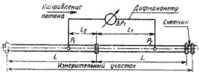
$\Delta P$  — потеря давления на участках трубопровода вверх и вниз по потоку;  $\Delta P_1 = (\Delta PL_1 + \Delta PL_2)$
