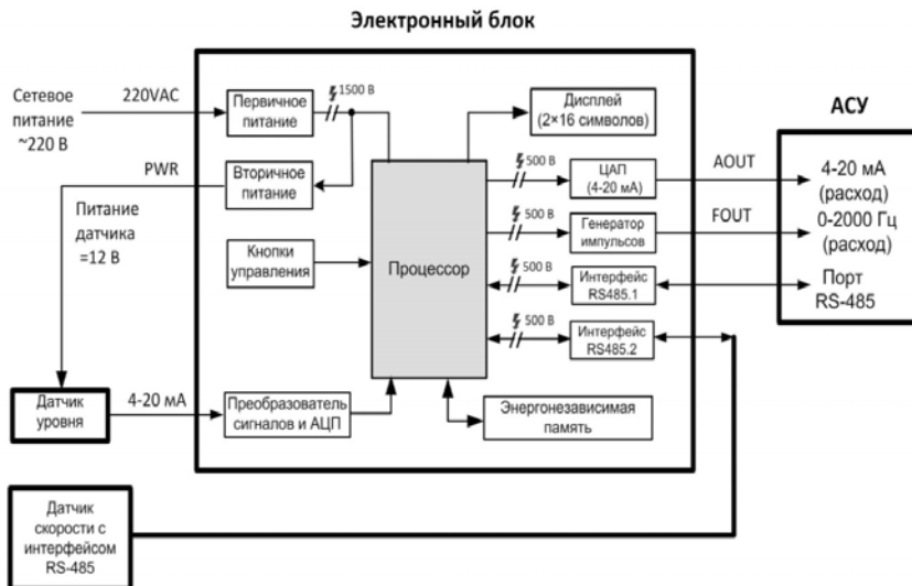
Рисунок 3.1 – Функциональная схема стационарного исполнения расходомера, поясняющая работу: а) базовая комплектация; б) типовой вариант для применения широкого перечня датчиков уровня и скорости
