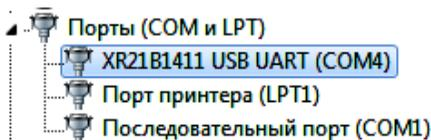
**Внимание!** Номер установленного виртуального COM-порта не должен быть больше 9. Если при установке адаптер (устройство **XR21B1411 USB UART**) получит номер COM-порта выше 9, то следует вручную изменить ему номер на номер  $\leq 9$  в нижеприведенном окне.
