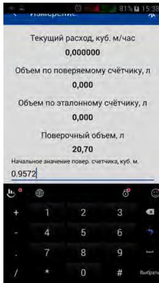
После ввода начального значения поверяемого счетчика следует подтвердить ввод, нажатием на кнопку **«Выбрать»**, далее нажать на кнопку **«СТАРТ»** и быстро (не более, чем за 2 секунды) открыть шаровый запорный кран на лицевой панели установки, обеспечивая расход.
