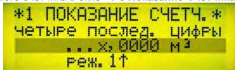
В данном окне вводится значение объема, считанного с табло поверяемого счётчика **с точностью до десятых долей литра** (четвертый знак после запятой), **считанные до старта поверки (до нажатия кнопки «СТАРТ»)** при перекрытом потоке и предварительно установленном значении расхода. После ввода четырех цифр для подтверждения правильности введенного значения нажимается кнопка «ВВОД». Далее, для возврата в окно «Старт РЕЖИМА 1» нажимается кнопка **▲** (подсказка **1↑**).
