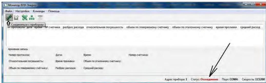
При этом статус соединения (если все настроено и подключено правильно) изменится с красного «Отсоединено» на зелёный – «Соединено», а кнопка соединения продолжит оставаться выделенной
