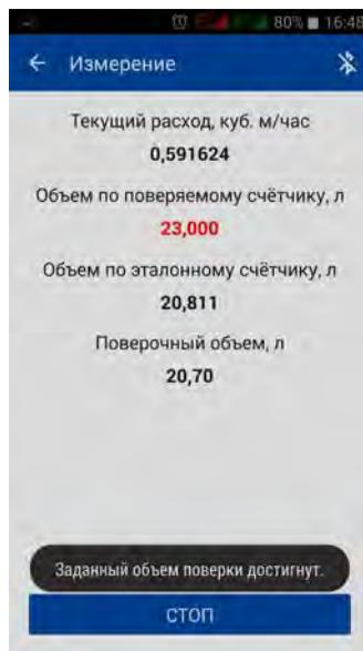
Фрагмент экрана при нажатии кнопки **«СТОП»**
