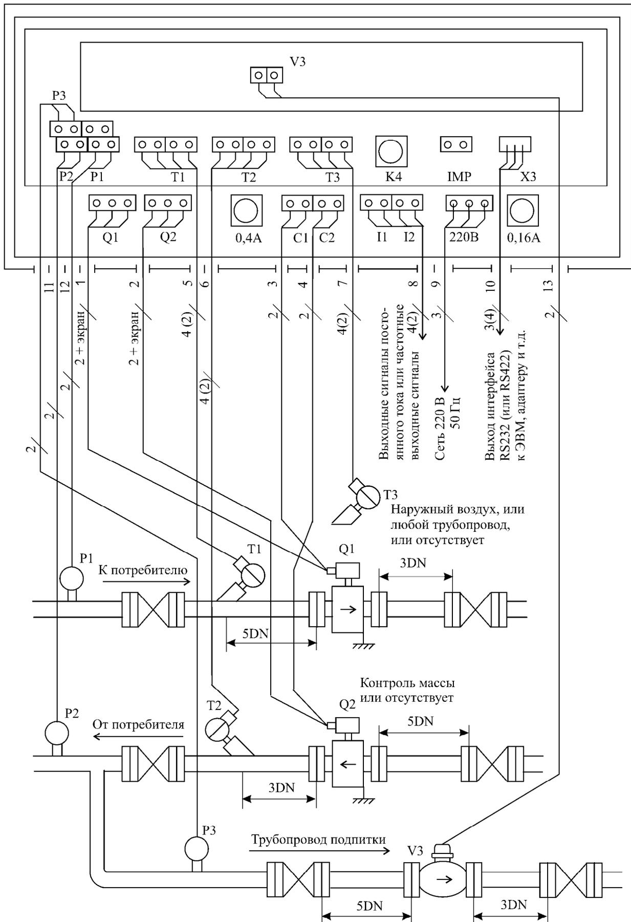
**Рисунок 15** – Пример установки теплосчетчика
