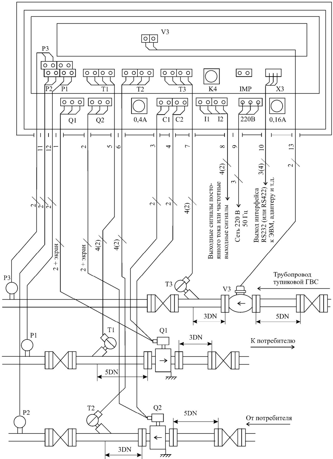
**Рисунок 13** – Пример установки теплосчетчика
