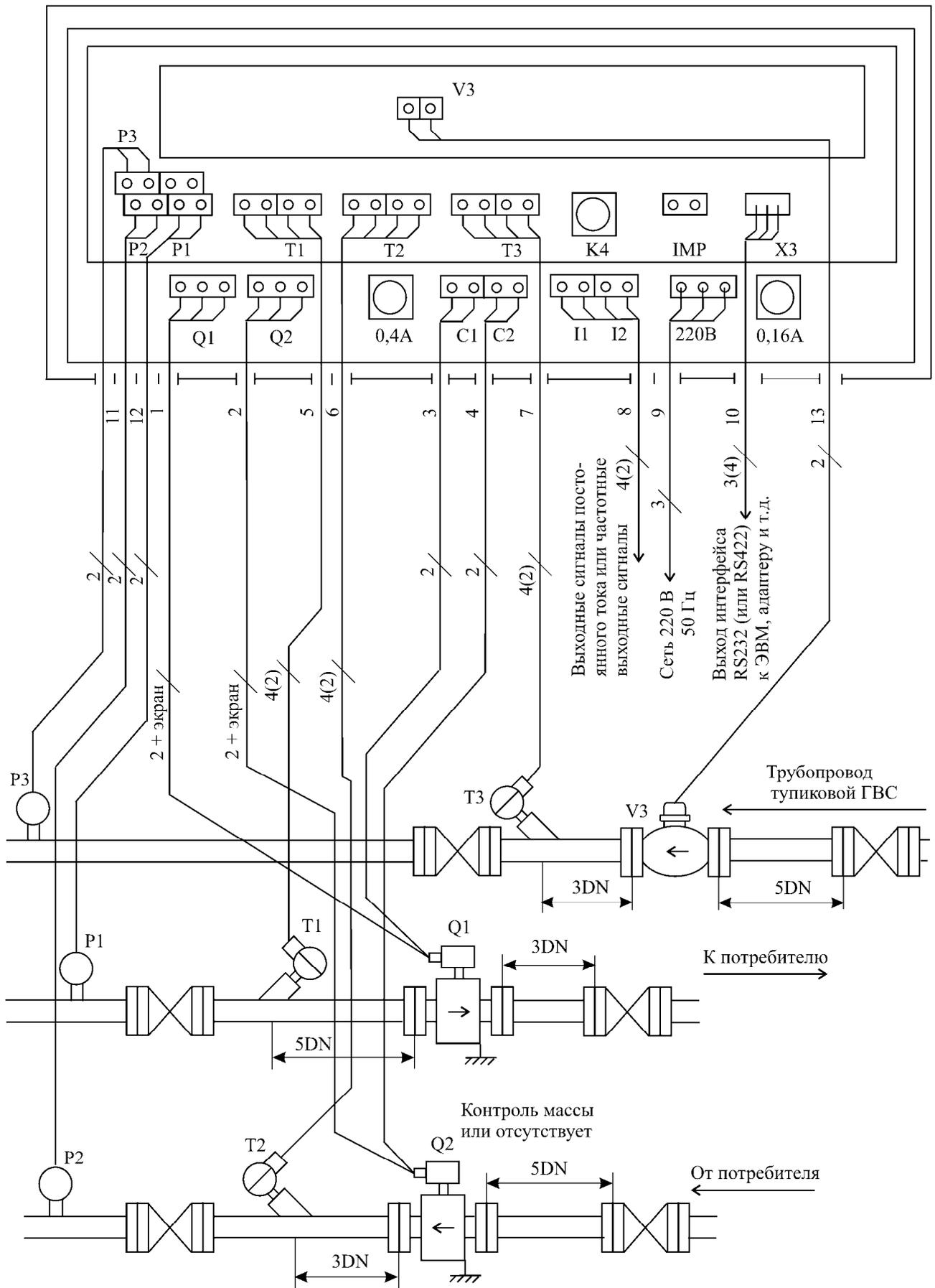
**Рисунок 18** – Пример установки теплосчетчика
