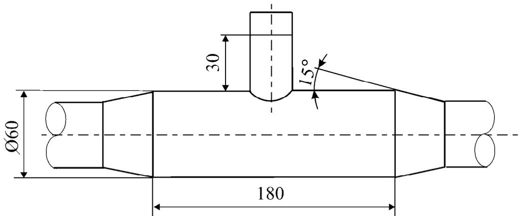
**Рисунок 21** - Установка защитной гильзы на трубопроводе при  $D_n < 50\text{ mm}$
