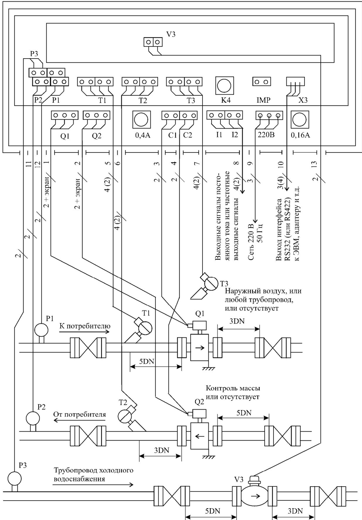
**Рисунок 19** - Пример установки теплосчетчика
