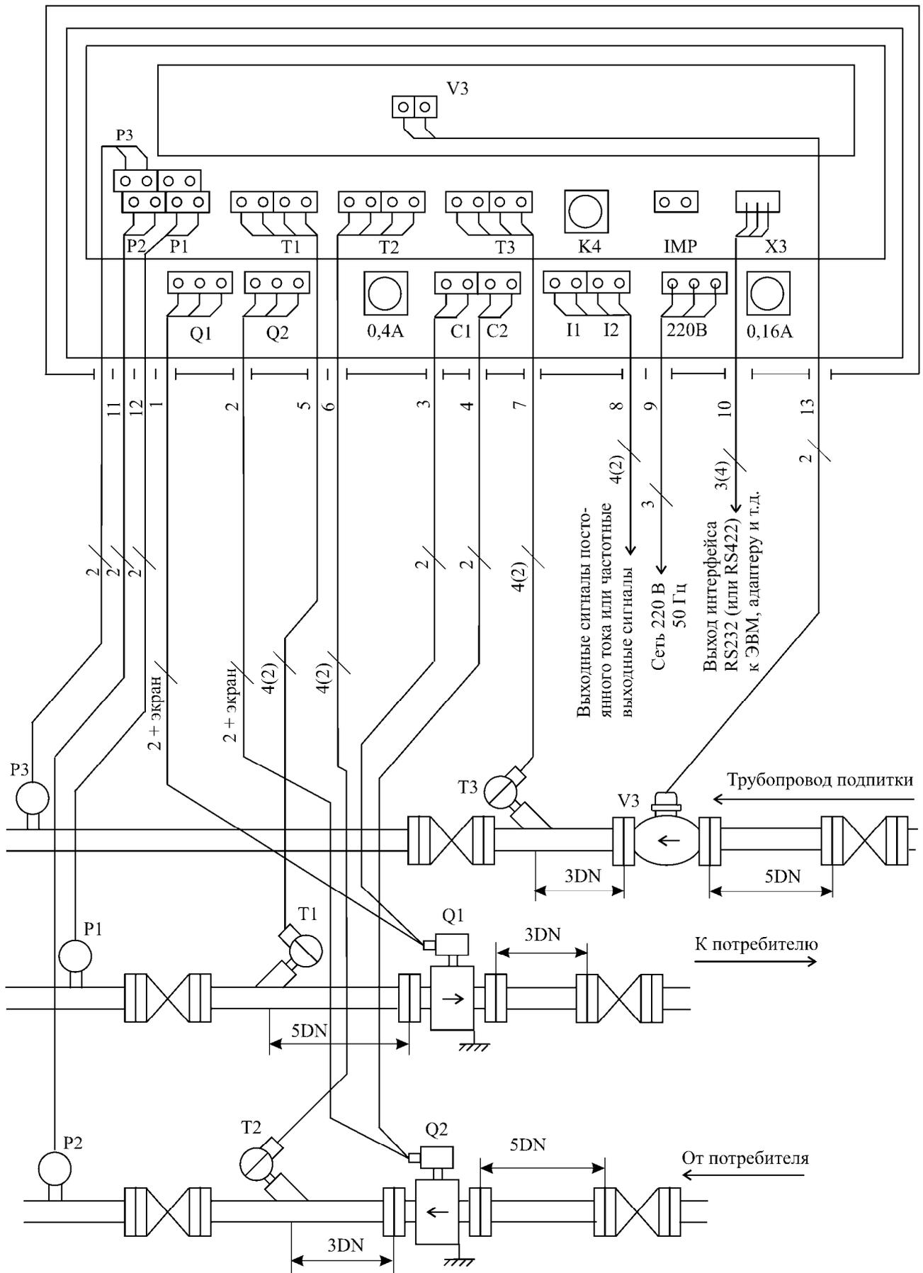
**Рисунок 12** – Пример установки теплосчетчика (Открытая система, режим: “Источник”)
