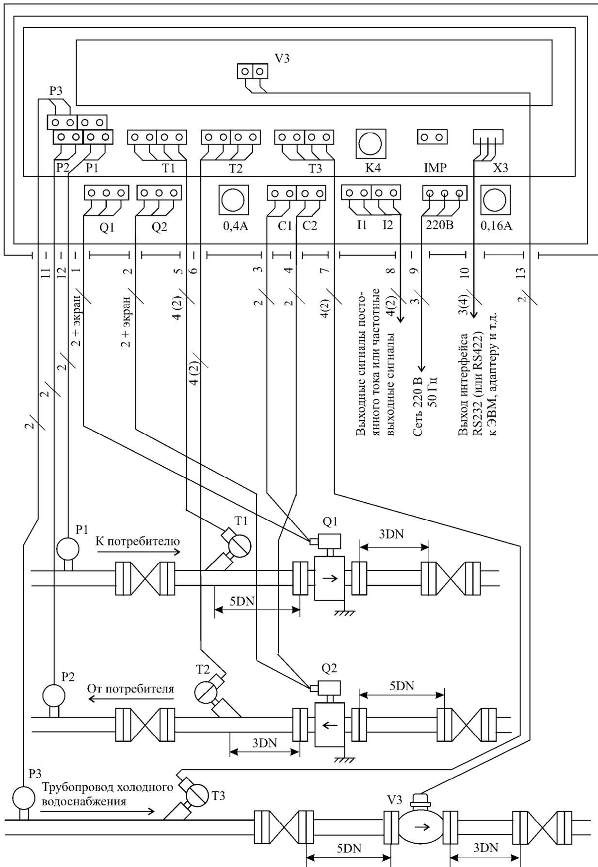
**Рисунок 14** – Пример установки теплосчетчика
