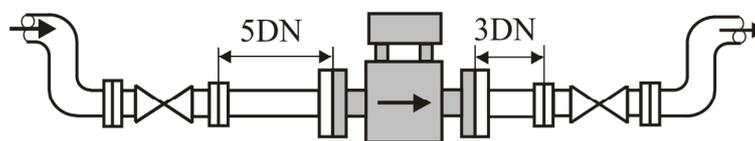
DN - условный внутренний диаметр трубы первичного преобразователя
