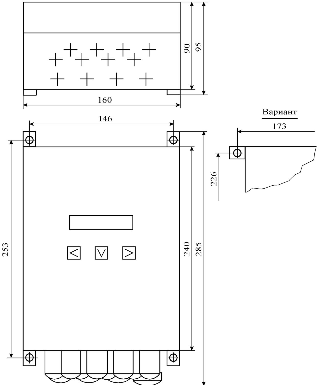
**Рисунок 4** - Габаритные и установочные размеры измерительного блока
