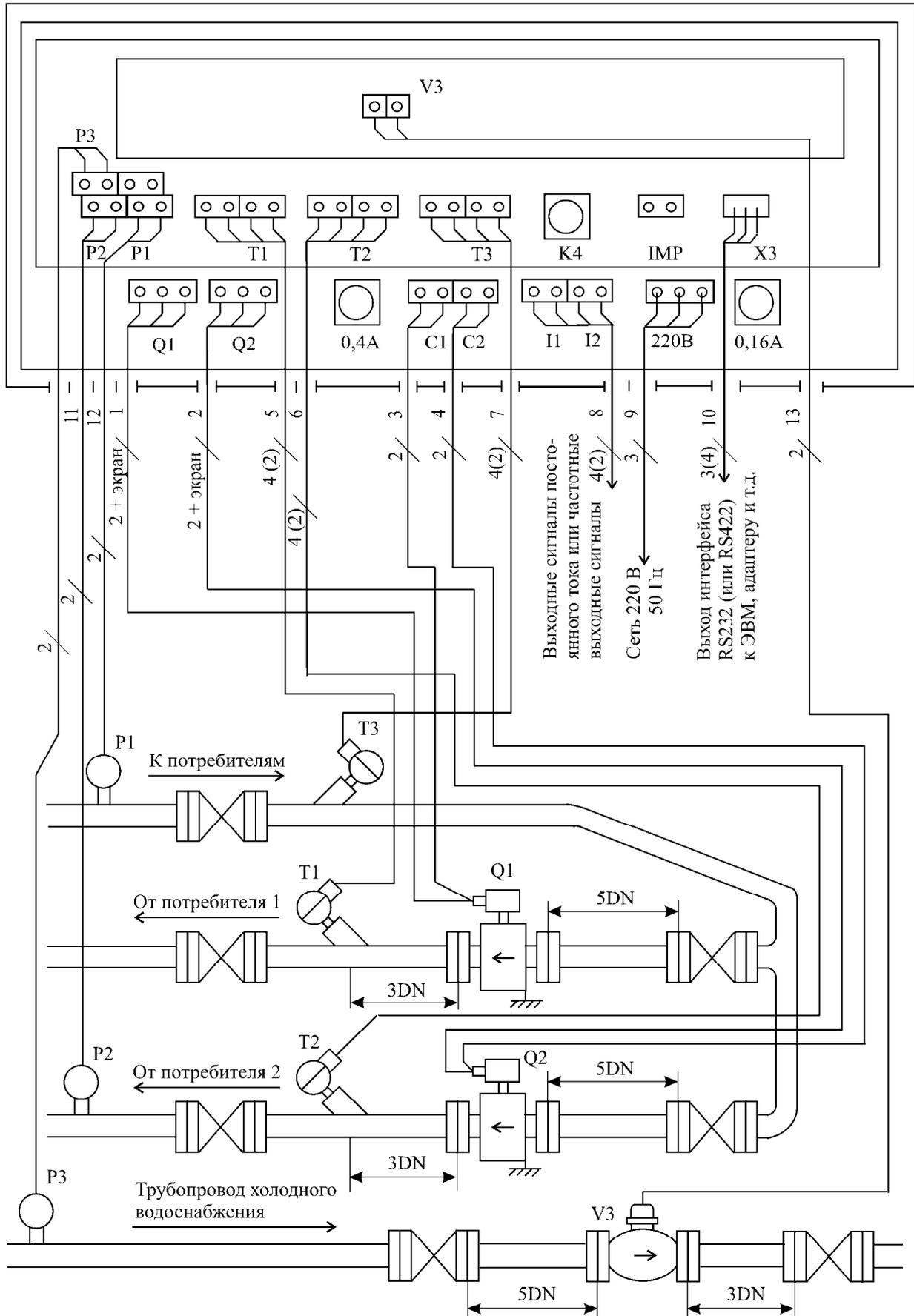
**Рисунок 20** - Пример установки теплосчетчика
