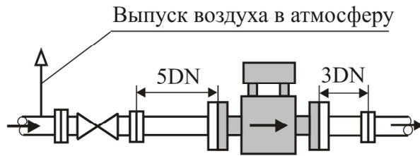
DN - условный внутренний диаметр трубы первичного преобразователя
