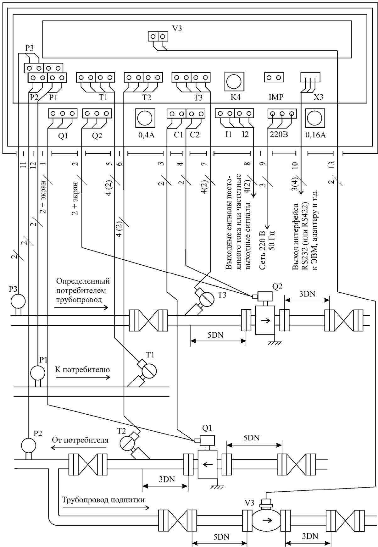
**Рисунок 17** – Пример установки теплосчетчика
