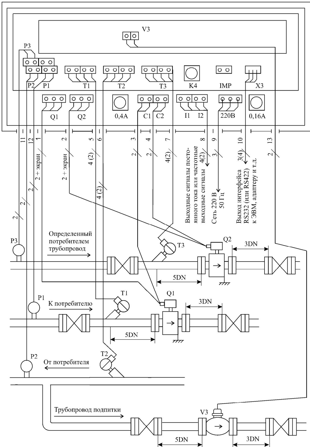
**Рисунок 16** – Пример установки теплосчетчика
