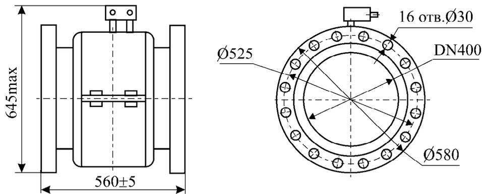
Присоединительные размеры фланцев по ГОСТ 12815-80 исполнение 1 на условное давление  $P_y$  1,6 МПа (16 кгс/см<sup>2</sup>), конструкция фланцев по ГОСТ 12820-80.
