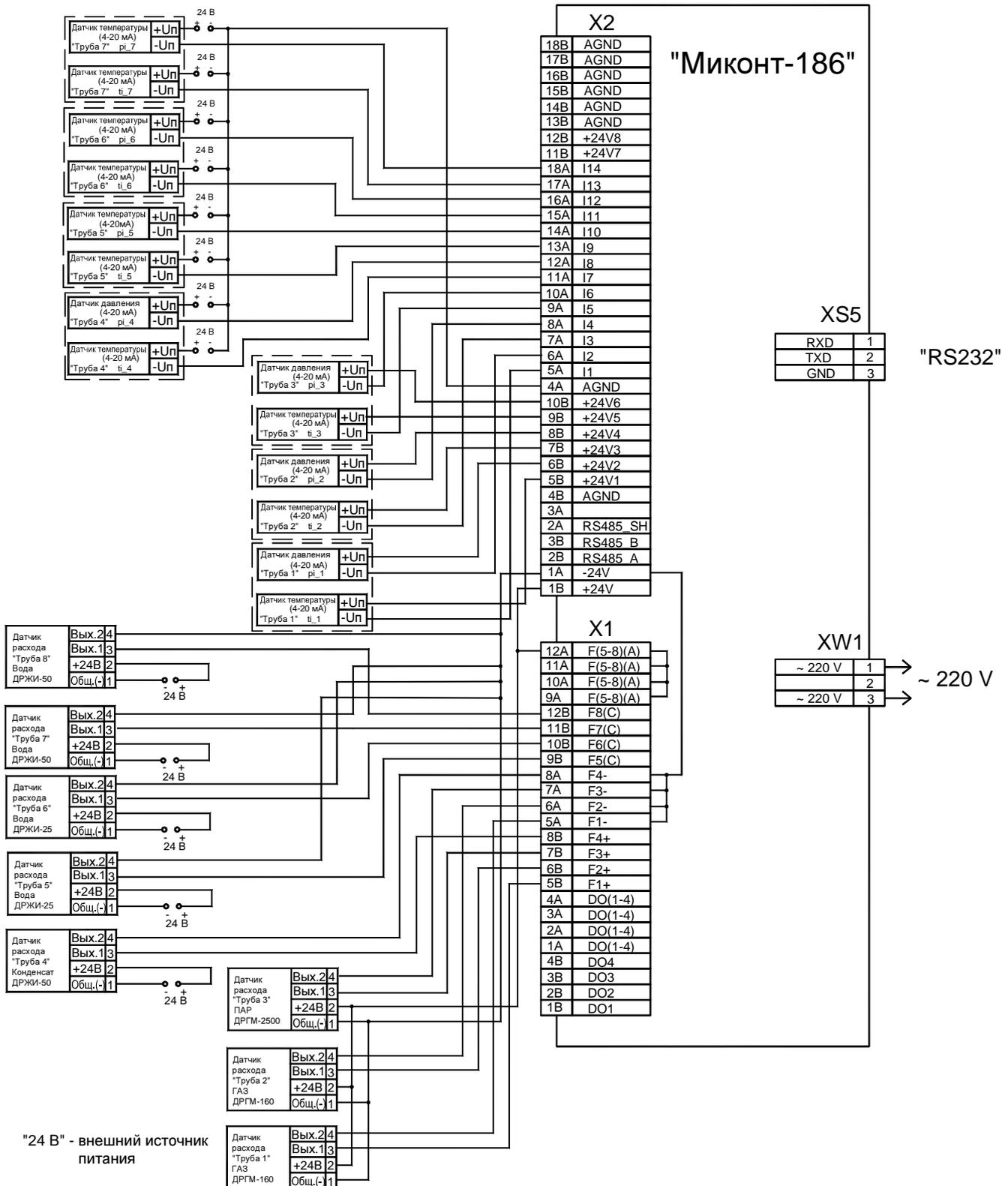
Рисунок Г.3 – Схема подключения контроллера
