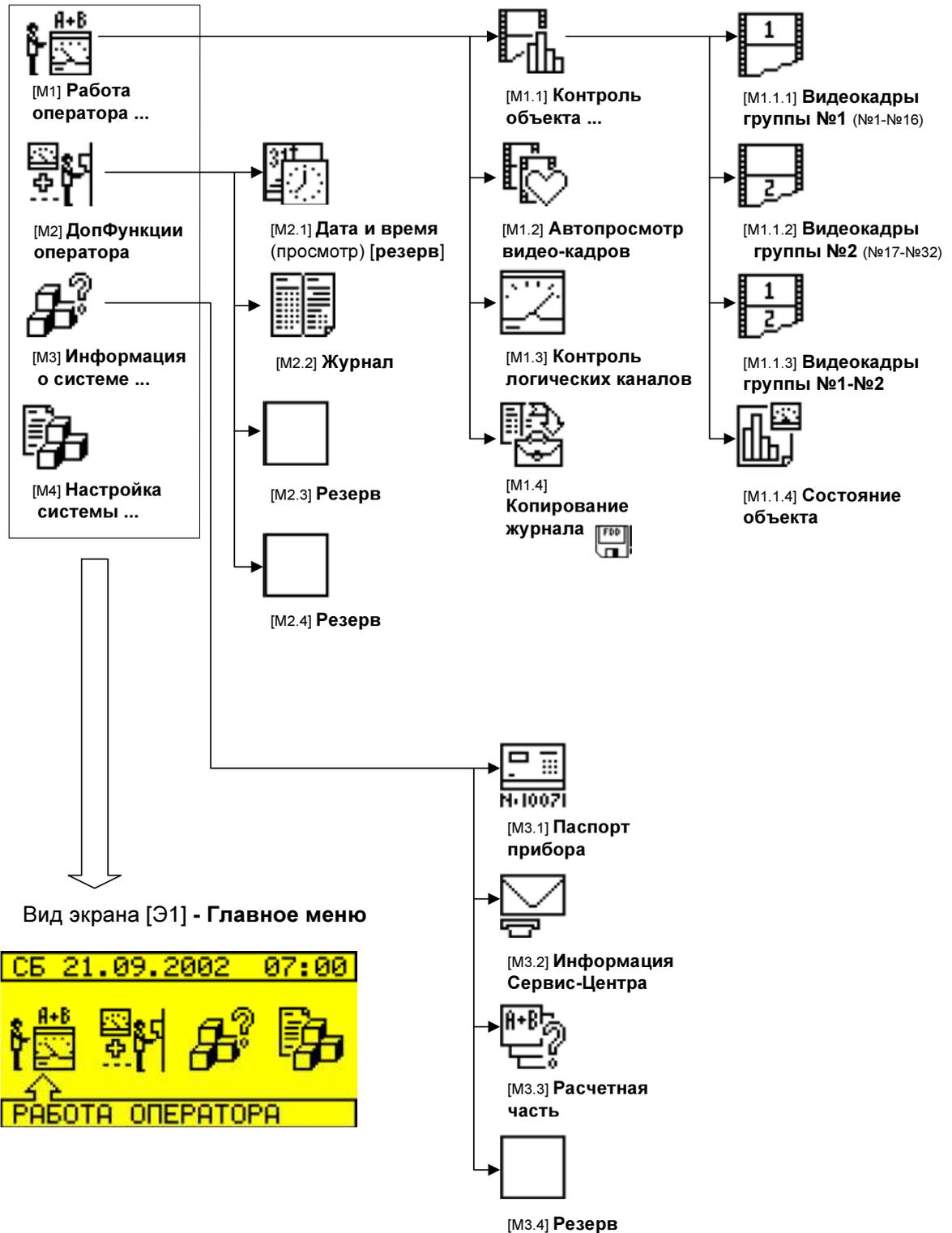
Рисунок Б.1 - Структурная схема видеопанелей контроллера.
