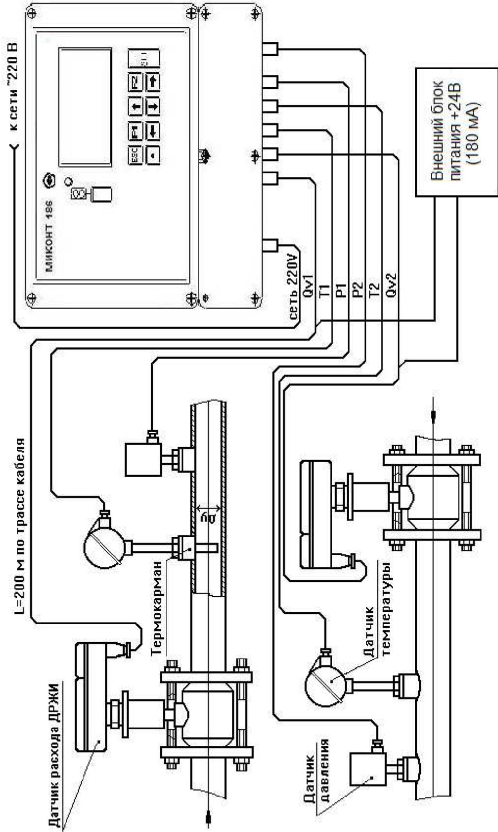
Рисунок В.3 - Счётчик тепла STC.M закрытая система. Общий вид
