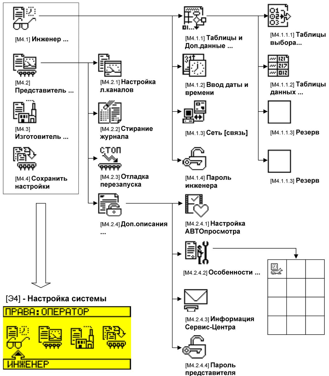
Рисунок Б.2 - Структурная схема видеопанелей настройки системы контроллера. Панель инженера
