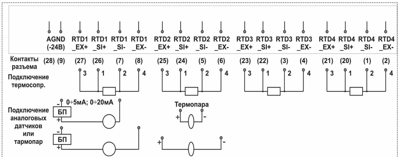
Рисунок 6 – Входные цепи каналов термопреобразователей сопротивления
