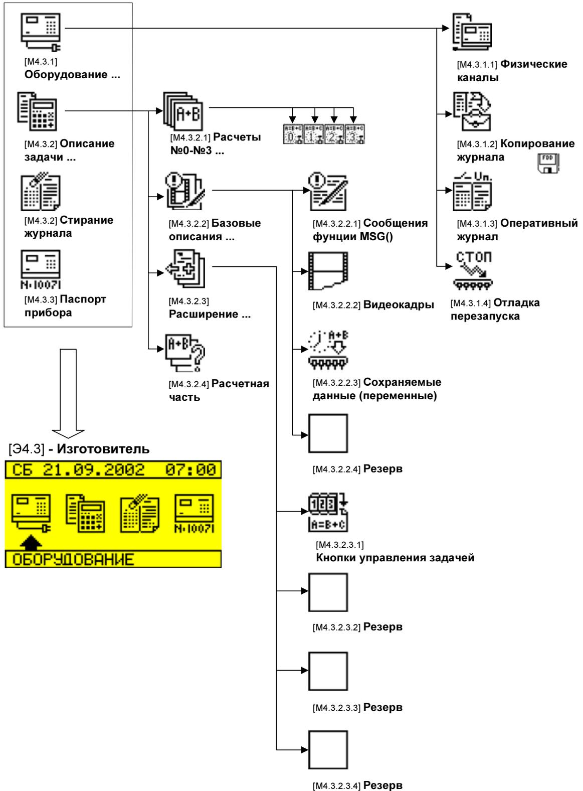
Рисунок Б.3 – Структурная схема видеопанелей контроллера.
