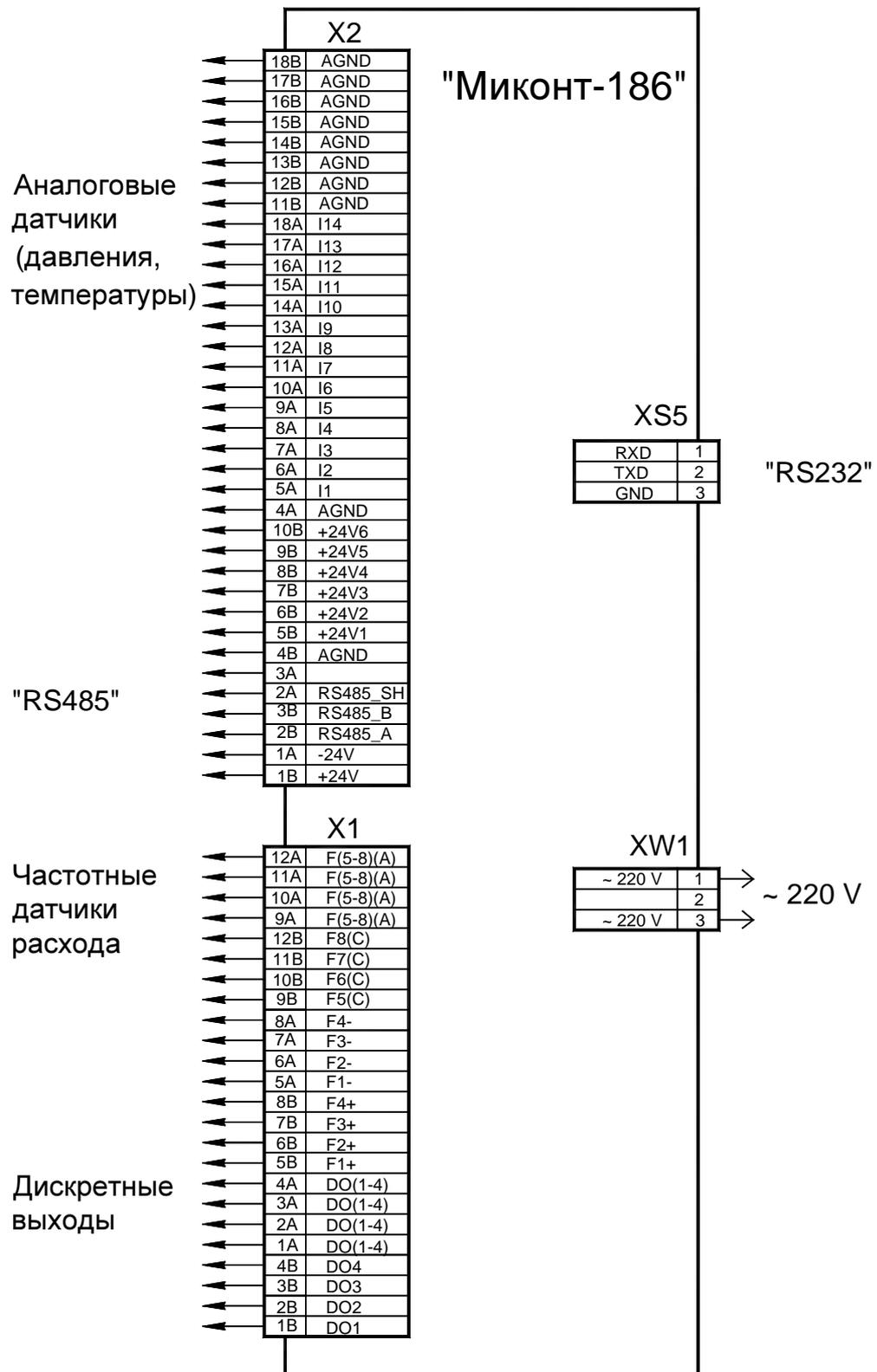
Рисунок Г.1 – Схема подключения контроллера
