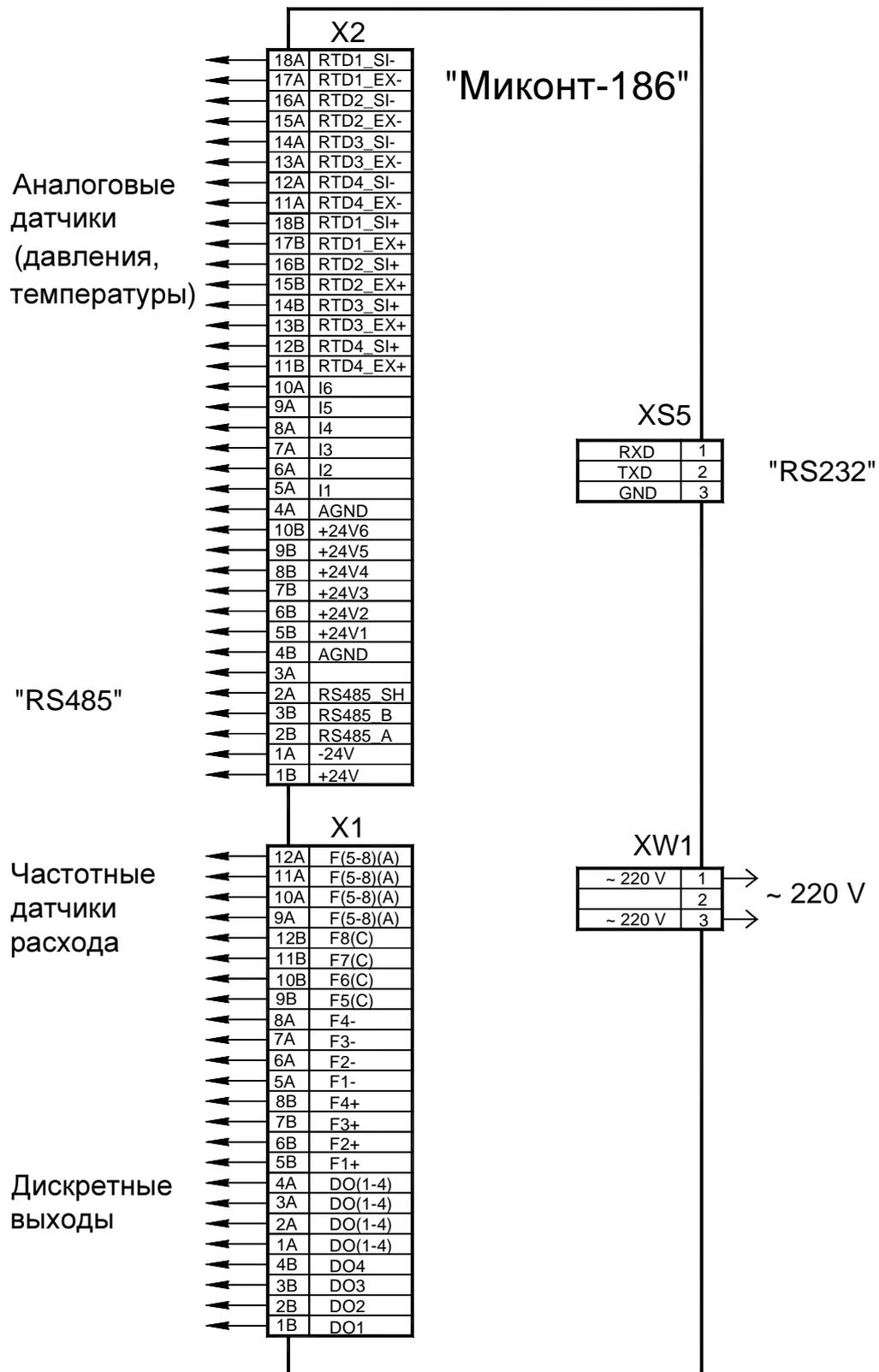
Рисунок Г.2 – Схема подключения контроллера
