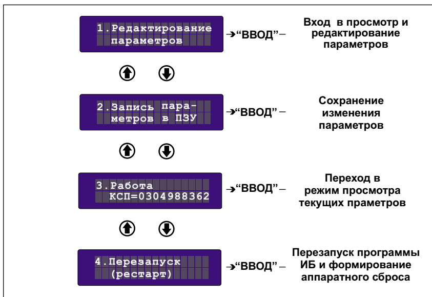
Рисунок 23.Схема управления индикацией режима просмотра и редактирования программируемых параметров.
