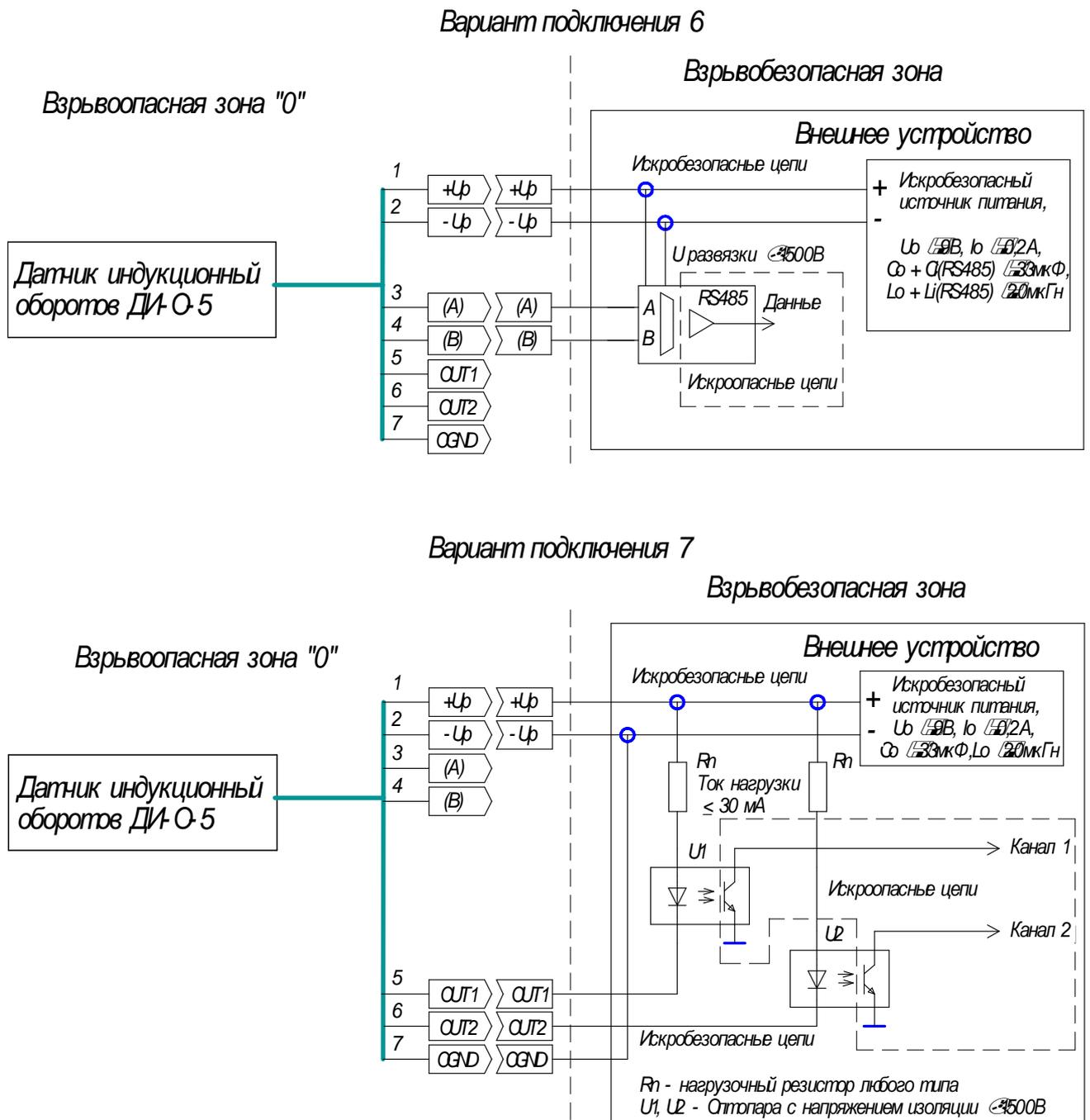
**Рисунок А.4 -** ДИ-О-5. Схема электрическая подключения для взрывоопасной зоны "0".
