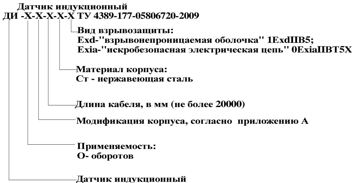
**Рисунок 1- Схема записи условного обозначения датчиков индукционных оборотов.**
