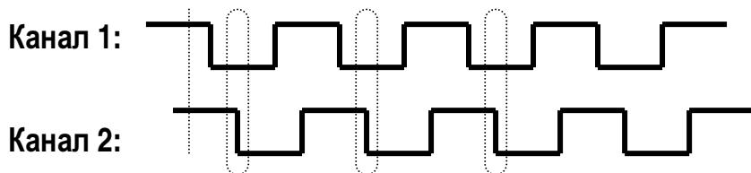
**Рисунок 2 – Диаграмма формирования импульсов по входным каналам ДИ-О-5.**
